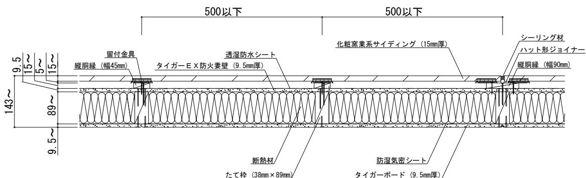
【窓業系サイディング縦張り(横胴縁)仕様】(中空部に断熱材を挿入した場合の壁構造)
